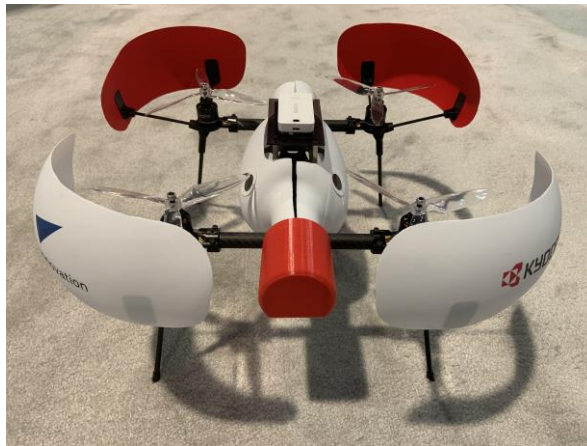
Musterdrohnen, die mit beweglichen Kommunikationsrelaisstationen ausgestattet sind
